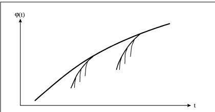
Рис. 7. График сложного процесса, в котором совмещается ряд асимптотических процессов с разными характерными временами
