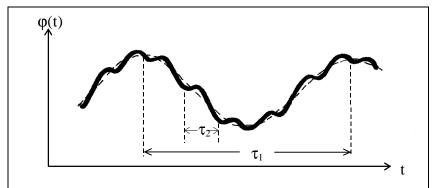
Рис.6. Характерные времена  $\tau_1$  и  $\tau_2$  процесса, в котором два гармонических колебания с разными частотами наложены друг на друга
