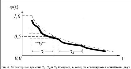
Рис.4. Характерные времена  $\tau_1$ ,  $\tau_2$  и  $\tau_3$  процесса, в котором совмещаются асимптоты двух порядков
