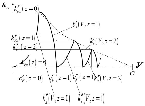
Рис.1. Алиасинг волнового вектора частицы
